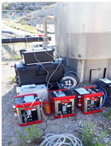
Prélèvement et analyse en cours des gaz de combustion (à gauche le 03/09/20, à droite le 03/12/20)
