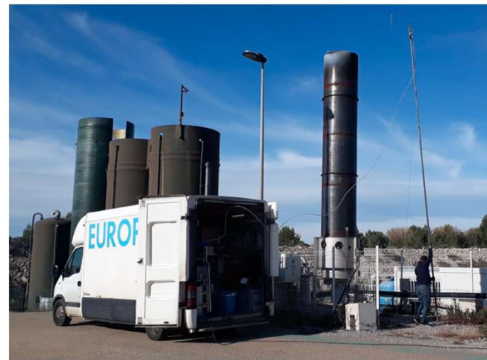
Prélèvement et analyse en cours des gaz de combustion (à gauche le 03/09/20, à droite le 03/12/20)
